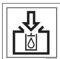
Llenado de depósito de aceite hidráulico
